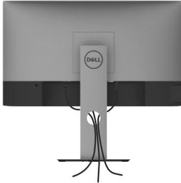
Organisieren Sie nach Anschluss aller erforderlichen Kabel an Ihrem Monitor und Computer (beachten Sie zum Kabelanschluss [Ihren Monitor anschließen](#)) diese wie oben gezeigt.
